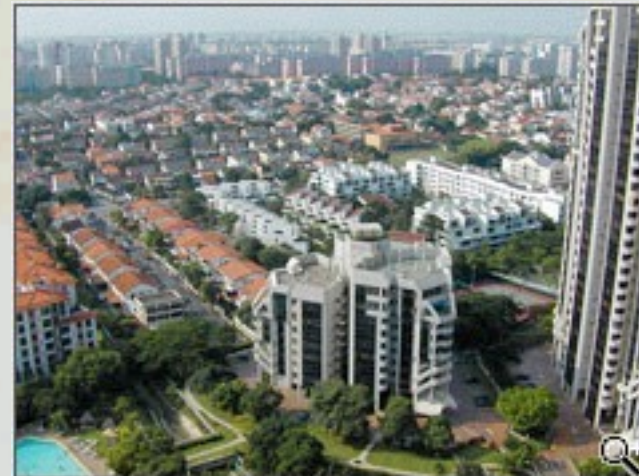
Typisk distortion hos linser med korta brännvidder (vidvinkelobjektiv)
